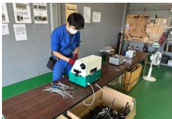
電線を機械に通して切れ目を入れます。安全な設計になっているので安心してできます。
