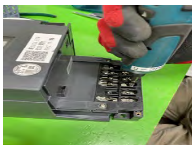
電気メーター解体作業
