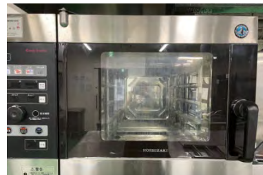
様々な調理の場面で活躍する「スチームコンベクション」です。時間、温度、3つのモードを切り替えて使います。
