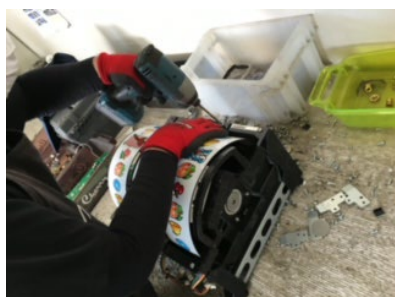
パチンコ・パチスロ解体作業
